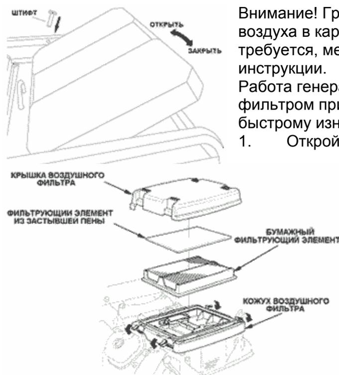
Внимание! Грязный фильтр не обеспечивает приток воздуха в карбюратор в нужном объеме. Если требуется, меняйте фильтр чаще, чем указано в инструкции.
